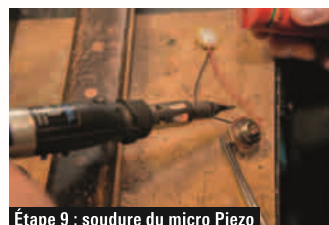
Étape 9 : soudure du micro Piezo
